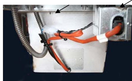
Εικόνα 3: Προσαρτήστε τους λευκούς συνδέσμους δύο πείρων και συνδέστε το μαύρο σύνδεσμο στο κιβώτιο συνδέσεων, όπως στην εικόνα.
